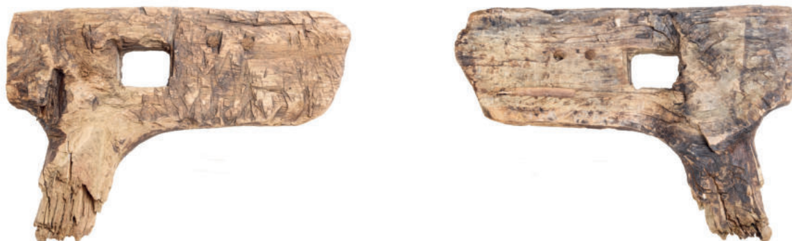
Figur 33. Tre arbetsbänkar för träbearbetning hittades i konstruktionen till en brygga. De hade till funktion att hålla byggnadsvirke på plats då det bilades. En av dessa konserverades, den är avsågad ena änden där ett prov för dendrokronologisk datering togs. Troligen har den använts i samband med arbete i området, vilket syns inte minst på de många verktygsspåren. När bygget var klart har den kasserats och återanvänts i bryggkonstruktionen. Foto: Markus Andersson.
